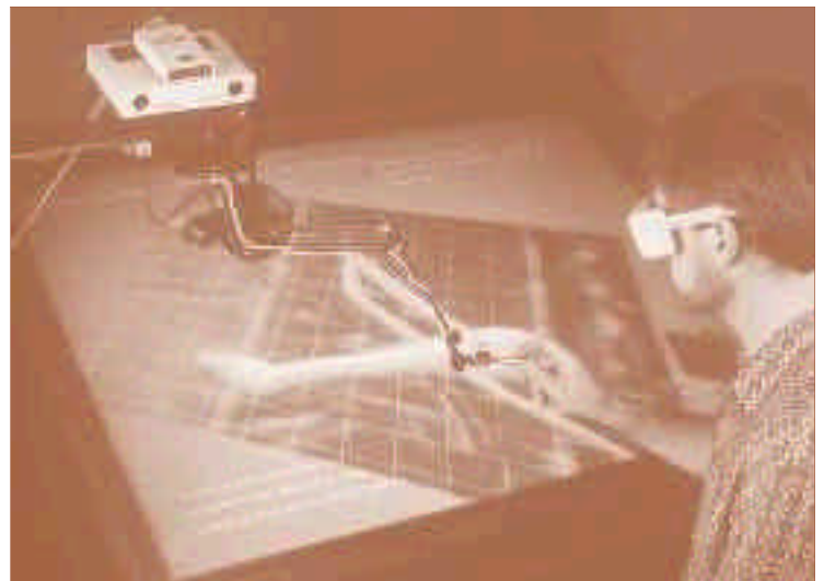
El físico Martin Guthold hace uso de una mesa de trabajo nanométrico, como parte de un sistema manipulador, para investigar las propiedades mecánicas y eléctricas de un montón de nano tubos de carbono. Foto de Larry Ketchum. Usada con permiso.
